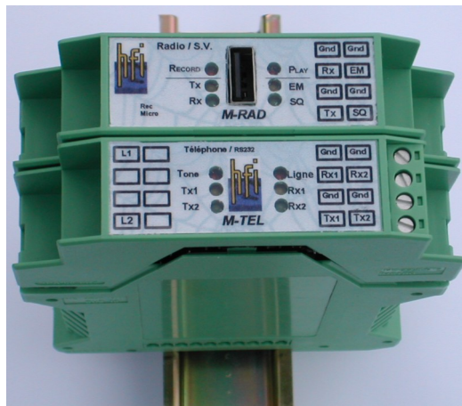
Vue de dessus de l'interface montée sur rail DIN DIM : H114 x L100 x P61
